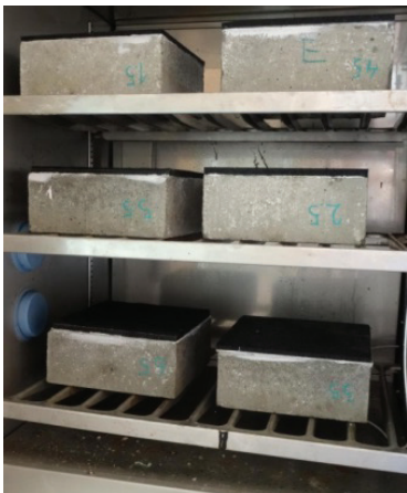
Rysunek 2.5. Próbkki podkładek USP w trakcie badań odporności na warunki atmosferyczne: a) próbki w komorze klimatycznej, b) komora klimatyczna z badanymi próbkami
