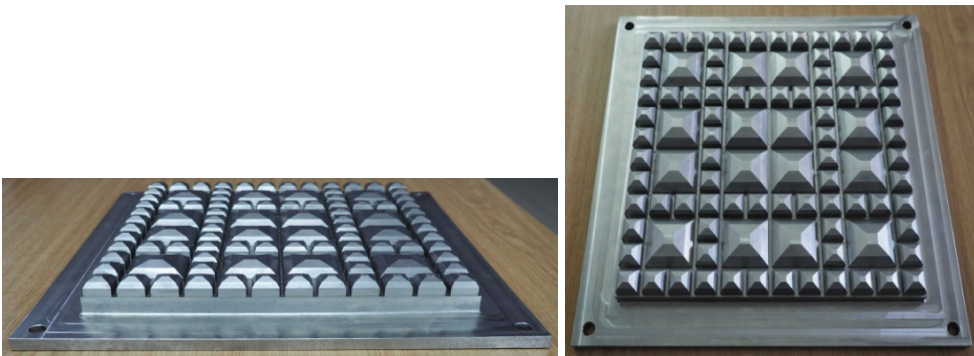
Rysunek 2.1. Profilowana symetrycznie płyta dociskowa/obciążeniowa GBP
