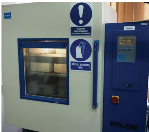
Rysunek 2.5. Próbkki podkładek USP w trakcie badań odporności na warunki atmosferyczne: a) próbki w komorze klimatycznej, b) komora klimatyczna z badanymi próbkami
